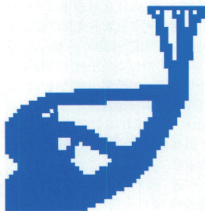
图14 结构的单纯拓扑优化设计
