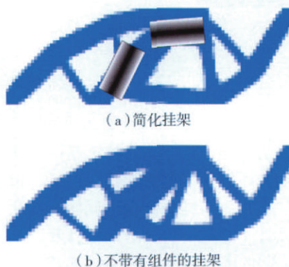
图10 简化挂架和不带有组件的挂架结构拓扑优化设计
