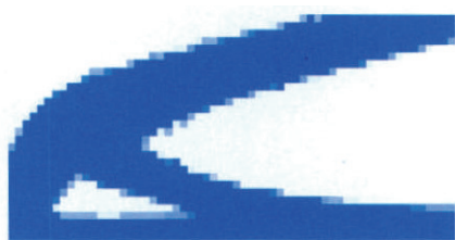
图19 不带组件带有惯性力的拓扑优化设计结果
