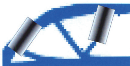
图20 带有质心位置约束的协同布局优化设计
